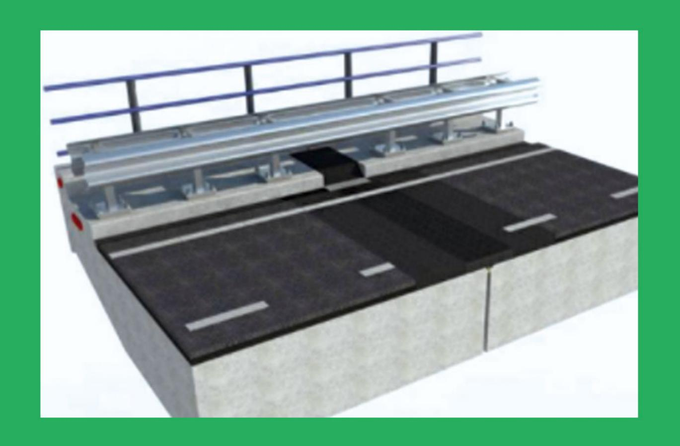
无缝拉伸胶可以同时兼顾高温和低温、渗透性和粘度的相反性能要求。不仅适用于温度单一的地区,也适用于温差较大的地区。
